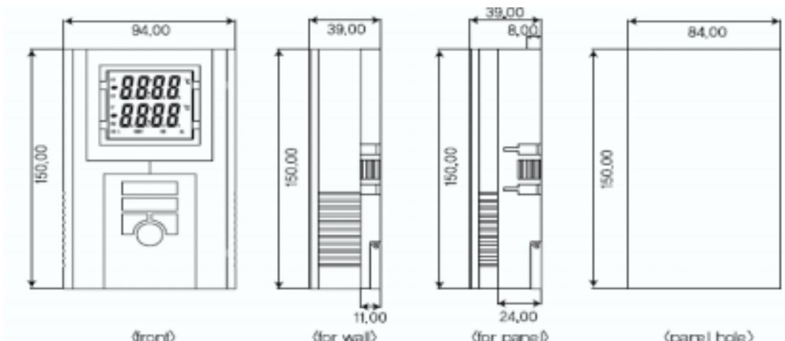
**Dimensionen (in mm) von links nach rechts:** Vorderansicht, Seitenansicht Wandmontage, Seitenansicht Schaltkasteneinbau, Dimensionen für Schaltkasteneinbau
